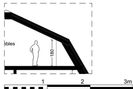
NOTA : La coupe en plan a été réalisée à 0cm par rapport au niveau du sol de façon a rendre compte des délimitations spatiales de chaque pièces sous rampant.
